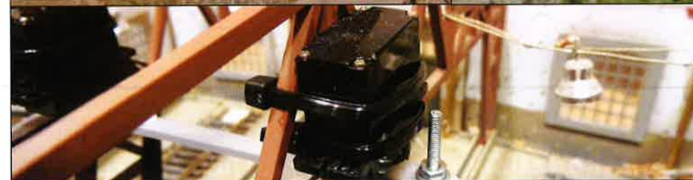
Comment ouvrir les portes d'une remise de manière réaliste : utiliser les servomoteurs de ESU. Voir FFN n°186 (2014-3).
